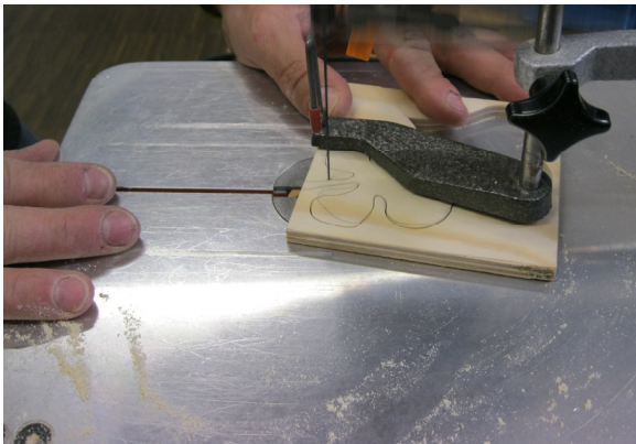
Aussägen der aufgezeichneten Blumenvorlage an der Dekupiersäge
