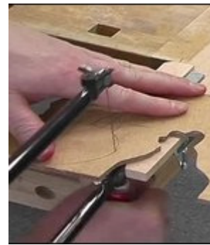
Sägen mit dem Laubsägetisch
