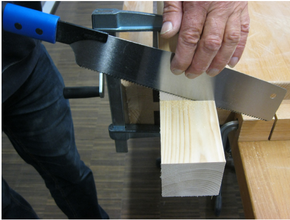
Ablängen mithilfe eines Führungsholzes
