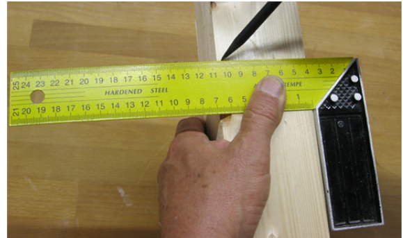
Anreißen mit Anschlagwinkel und Bleistift
