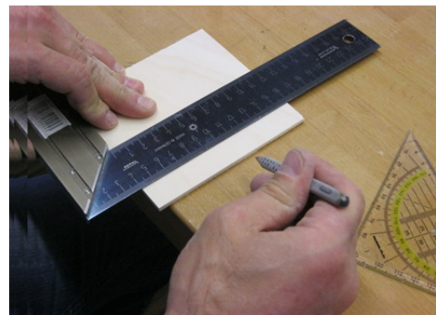
Übertragen des Planes auf die Grundplatte. Zuerst wird ein Gittermuster mithilfe des Anschlagwinkels gezeichnet
