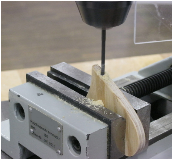
Bohren der Bohrung für den Schaschlikstab (Bohrdurchmesser je nach Durchmesser des Schaschlikstabes wählen. Zum Bohren das ausgesägte Teil im Maschinenschraubstock fest einspannen.)
