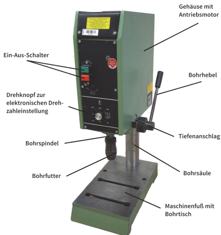
Aufbau und Bauteile der Tischbohrmaschine
