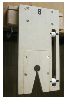
Laubsägetisch mit austauschbarem Einsatz und Langloch mit Rollen zum Spannen der Laubsäge
