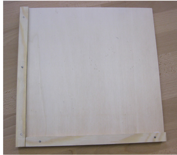
Grundbrett mit montierten Leisten
