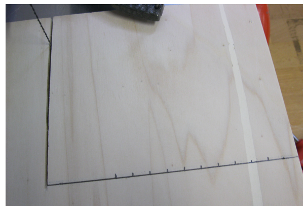
Kreisschneidevorrichtung nach dem ersten Schnitt mit Hilfslinie und Bohreinteilung
